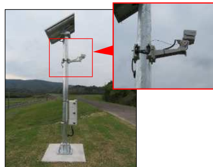
簡易型河川監視カメラ
