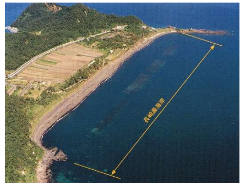
面的防護方式の採用（写真：長崎鼻海岸）
